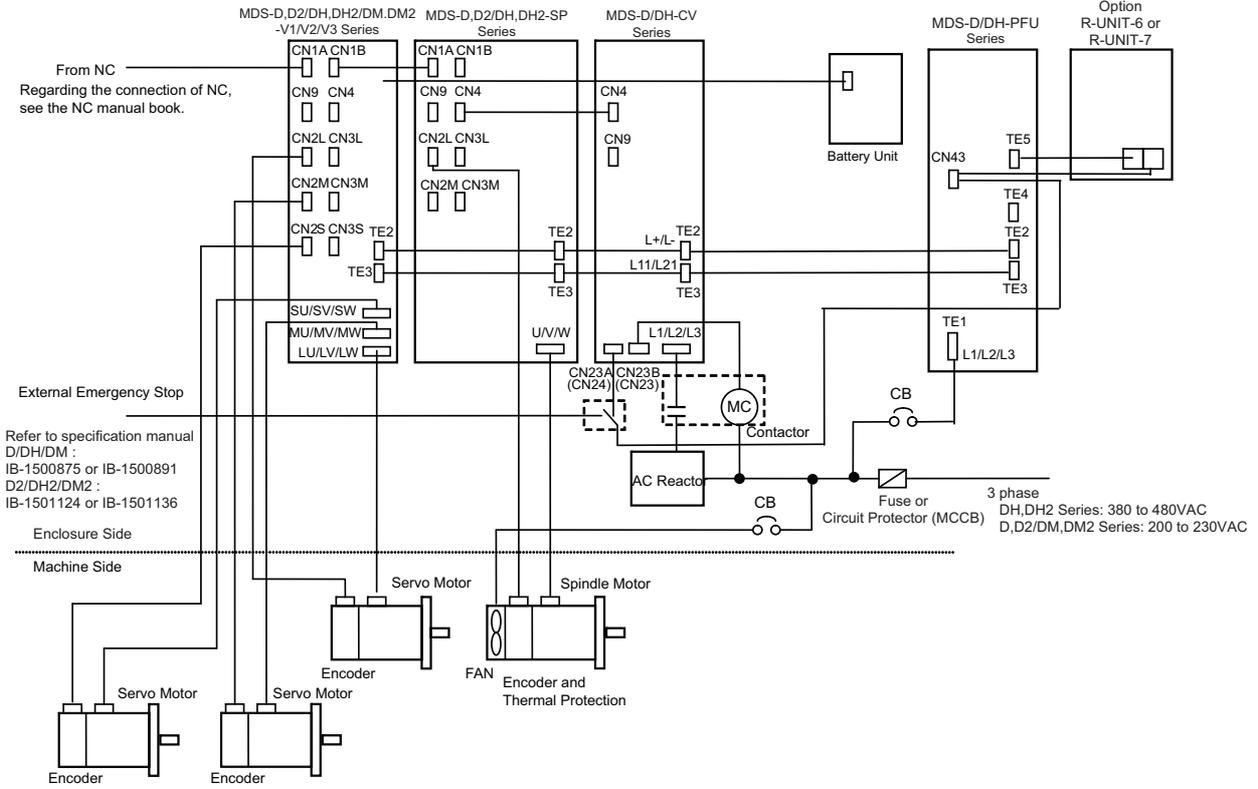
**Appendix 4-3-3 MDS-D2/DH2-CV, D/D2-Vx/SPx, DH/DH2-Vx/SPx, DM/DM2-V3 Series
